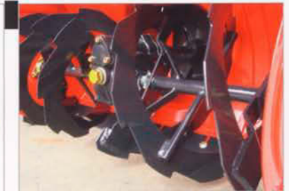
Das Design des Fräskopfes ermöglicht auch bei Schneematsch oder gefrorenem Schnee eine hohe Arbeitsgeschwindigkeit.
