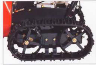
Die Führungsräder der Raupen sind aus robustem Stahlguss gefertigt. Sie garantieren eine spursichere Vorwärtsbewegung auch bei geneigtem Gelände.
